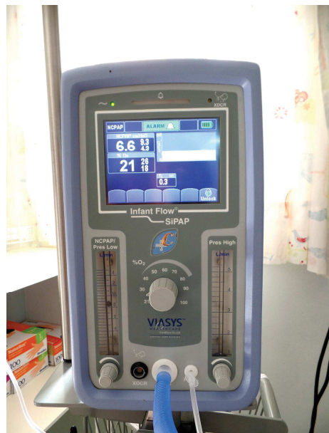
Imagen 8. Sistema de VMNI en modalidad de Presión Continua Positiva en la Vía Aérea. Fuente: elaboración propia. Ferrera Fernández, MA.
