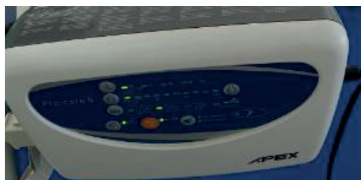
Imagen 14: Compresor de una SEMP Dinámica (reactiva con motor). Tiene modalidad de baja presión constante y alternancia. Además, presenta las alarmas sonoras y visuales. Fuente: Pablo García Molina, Hospital Clínico Universitario de Valencia
